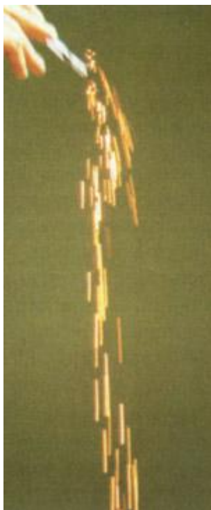
Abbildung 8: Pyrophores Eisen beim Ausschütten aus einer Schutzgas-Ampulle
