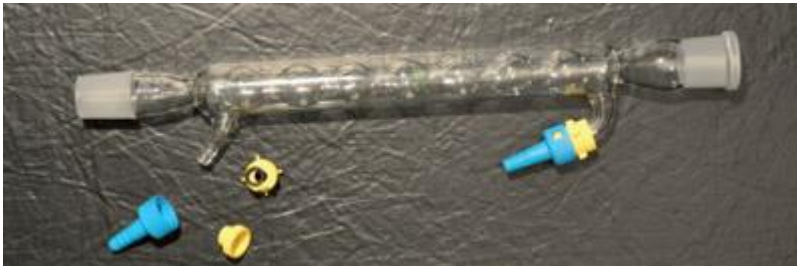
Abbildung 11: Kühler mit Glasoliven für den Kühlwasseranschluss mit Adaptern, die Kunststoff-Schnellkupplungen nachrüsten.
